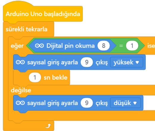
Şekil 5.60. mBlock buton Led Kodları
